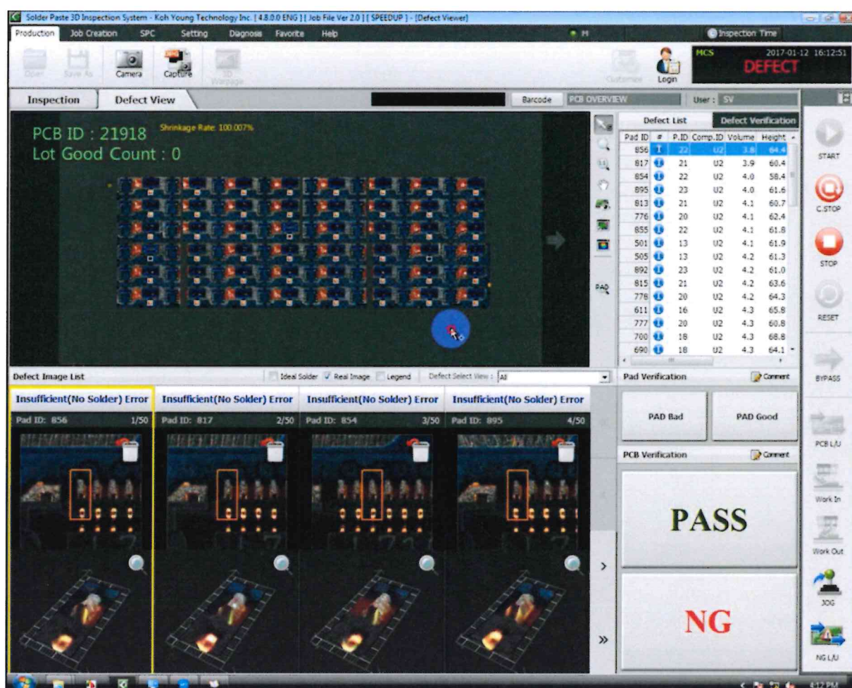
Программно-аппаратный комплекс Solder Paste 3D AOI inspection system от Koh Young Technology Inc.
